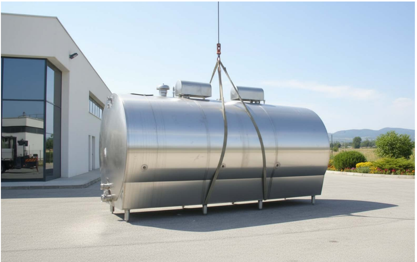
Δεξαμενή αποθήκευσης σε οριζόντια διάταξη
